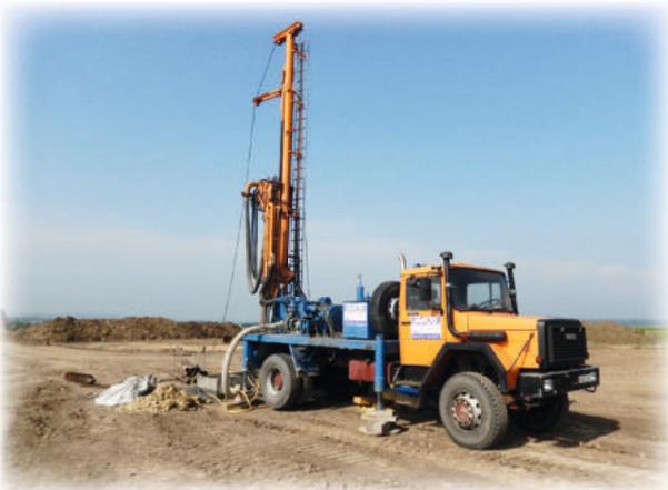
*Bohranlage für Grundwassermessstellen*
