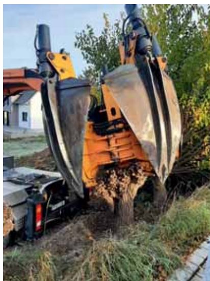
Mit Hilfe einer Rundspatenmaschine werden die Maulbeeren verpflanzt. (Foto: Stadt Burgbernheim)
